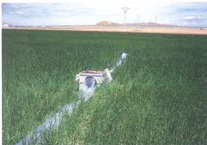
Foto 1. Prototipo para riego secuencial de parcelas de forma automática.
