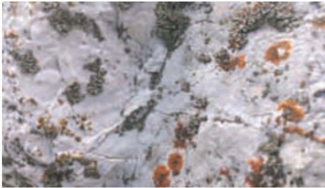
Aspecto de fractura concoidea en la superficie de la piedra. Foto 4.
