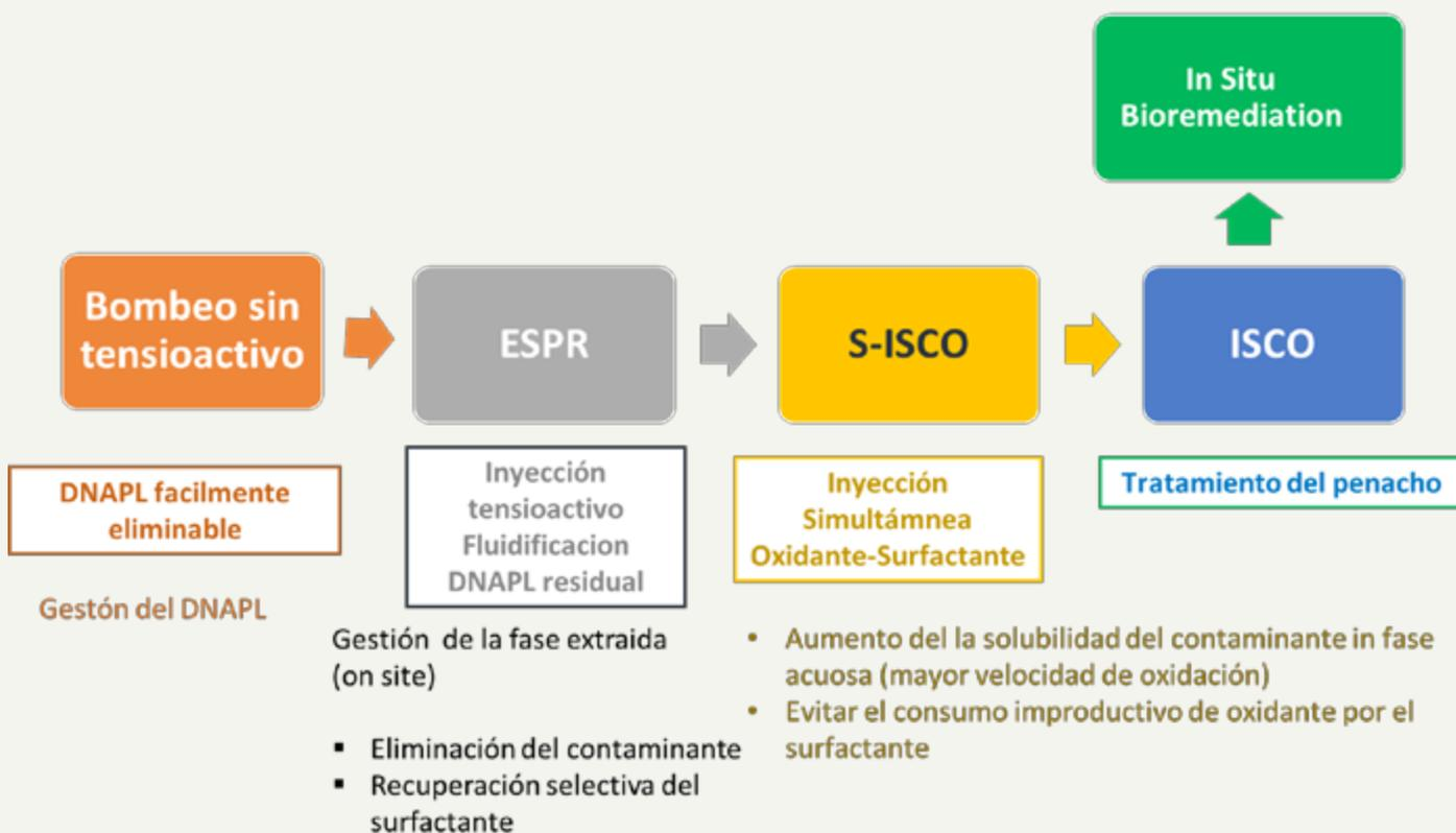
**Figura 6. Tren de tratamiento para la remediación de emplazamientos contaminados por DNAPL (elaboración propia).**
