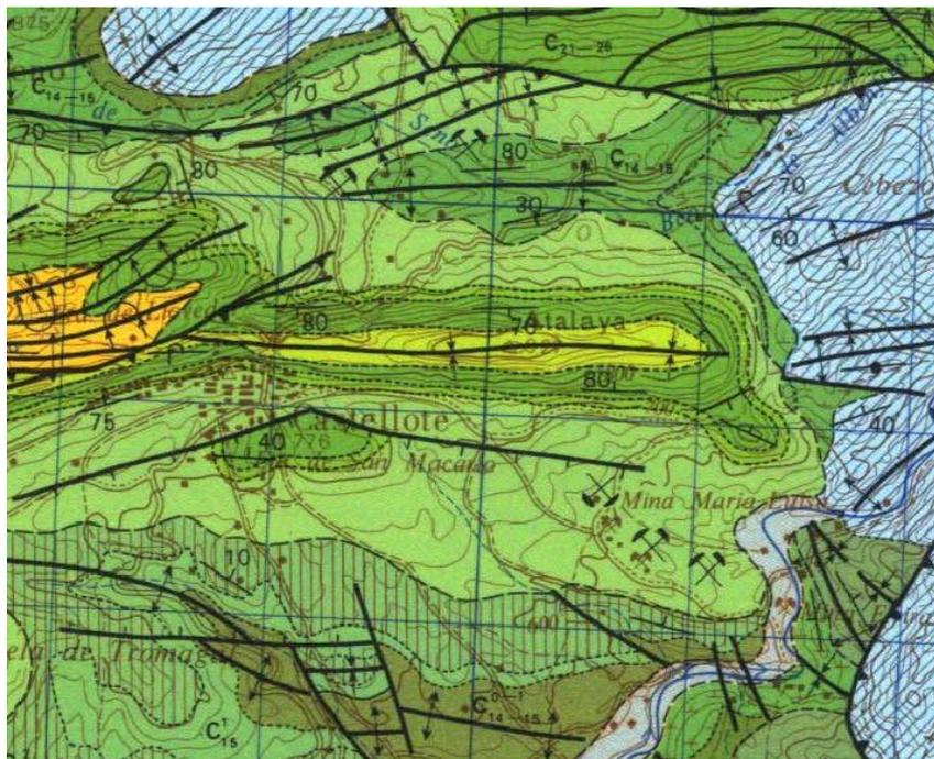
*Figura 3.6. Detalle del mapa correspondiente a la Hoja 519-AGUAVIVA en el que las minas o canteras se representan con dos martillos cruzados, invertidos en el caso de las explotaciones abandonadas. Fuente: Mapa Geológico de España 1:50.000 (IGME, 1979).*
