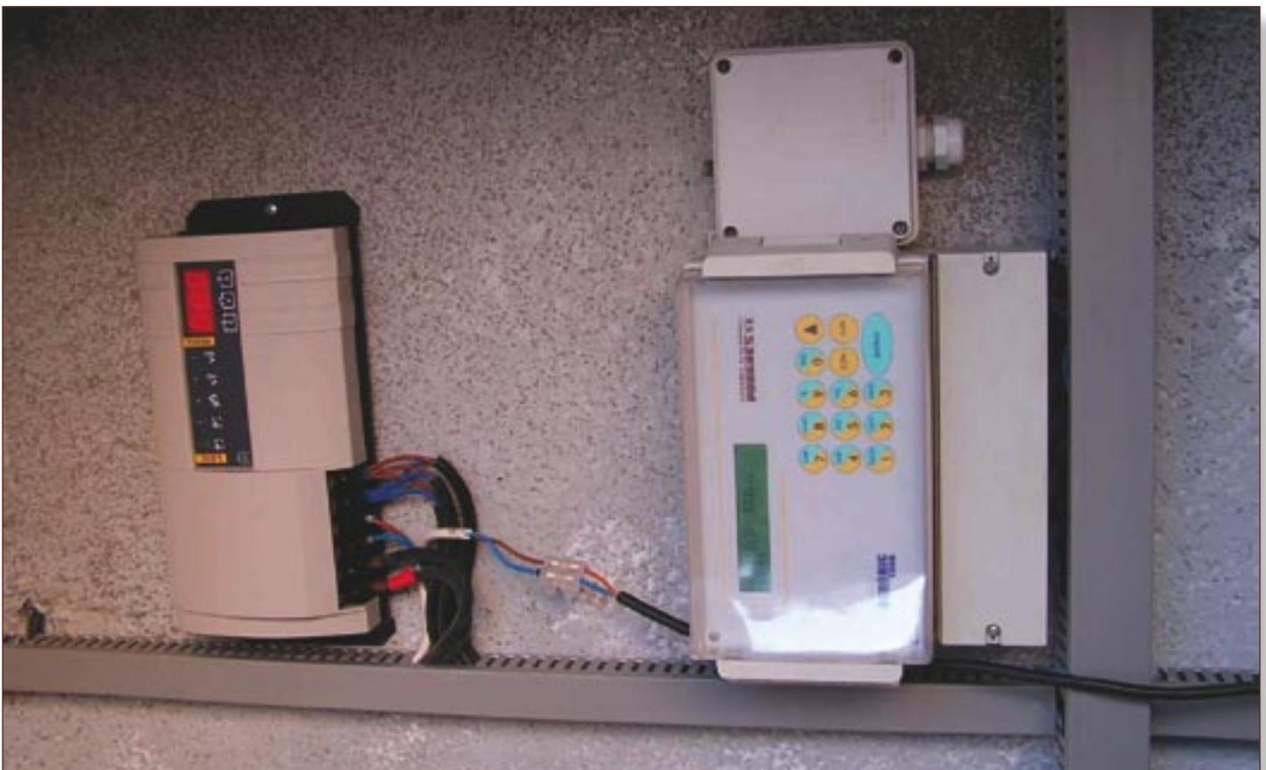
Foto 2. Programador de riego en parcela. Permite ajustar el tiempo de riego en cada sector en función de las necesidades hídricas del cultivo.
