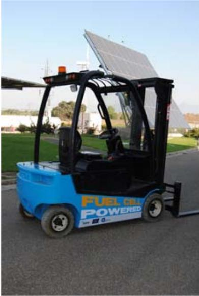
Carretilla con powerback de pila de hidrógeno.
