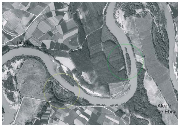
◀ Figura 23: Foto a rea de la zona entre Luceni y Alcal de Ebro (Zaragoza), donde se ven diferentes canales trezados del r o Ebro. En amarillo los ya colmatados por sedimentos y en verde los a n funcionales (Modificado por I. G mez).
