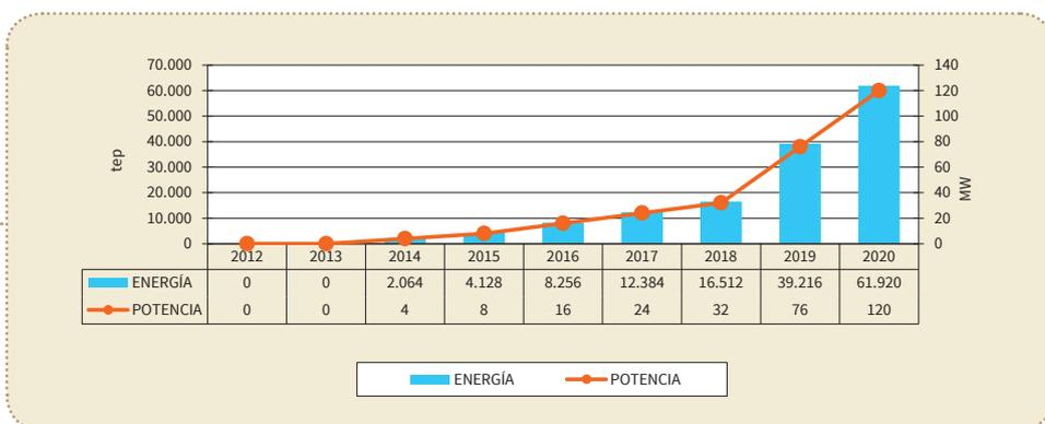
Con las consideraciones anteriores se supone una potencia instalada en 2020 de 120 MW, lo cual equivale a una producción de energía eléctrica acumulada durante el periodo 2013 – 2020 de 1.680.000 MWh y una producción de energía en 2020 de 720.000 MWh, estimando 6.000 horas de media de funcionamiento anual.
