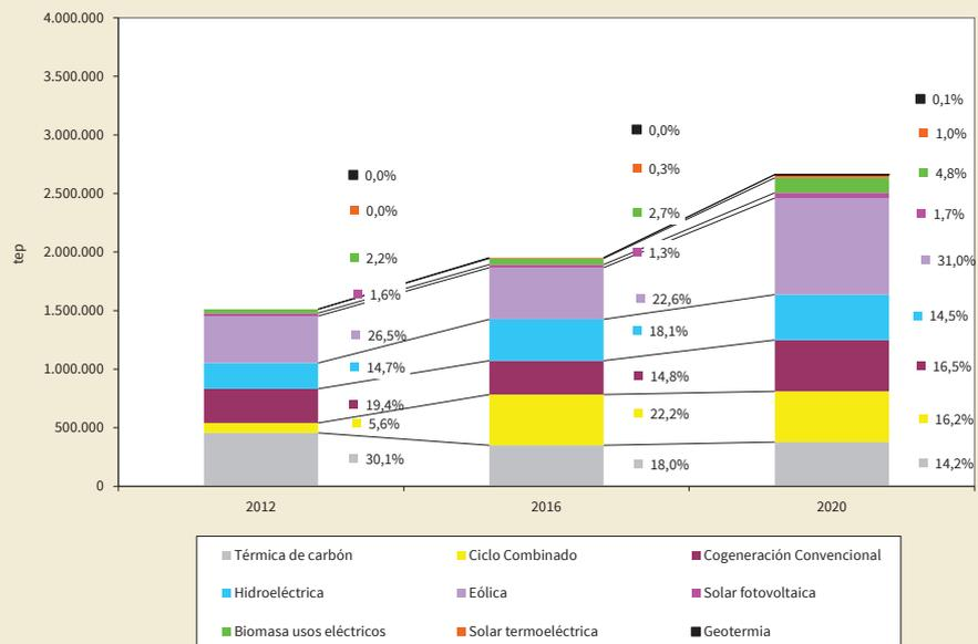
Las centrales térmicas de carbón en 2012 suponían un 17,2% del total de potencia instalada y en 2020 este porcentaje desciende al 10,4%. Respecto a su porcentaje de participación en la estructura de producción se observa que en 2012 era del 30,1% bajando en 2020 al 14,2%.
