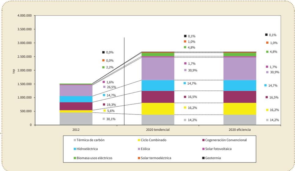
En el caso de la generación térmica existe una leve diferencia entre ambos escenarios. La mayor parte de esta energía térmica es generada mediante biomasa. La diferencia entre ambos escenarios es de 19.819 tep, que suponen una diferencia del 10% aproximadamente entre ambos escenarios. El incremento en el periodo 2012 – 2020 es del 26,6% y del 12,1% para los escenarios tendencial y de eficiencia respectivamente.
