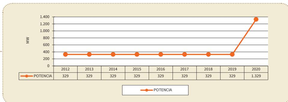
Teniendo en cuenta la previsible ampliación de alguna instalación existente y el desarrollo de algún nuevo proyecto, se ha estimado para Aragón un incremento de potencia instalada de 1.000 MW, pasando de los 329 MW actuales a 1.329 MW en 2020.
