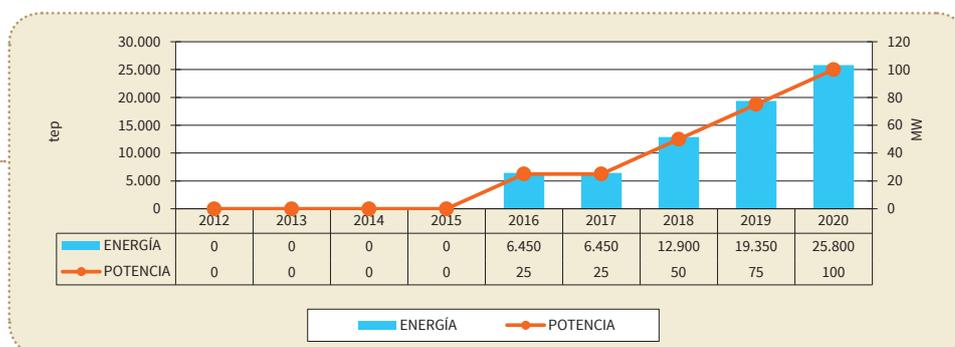
A lo largo del periodo 2013 - 2020 se ha estimado la instalación de 100 MW, en base a la puesta en marcha de 4 plantas de 25 MW, lo que conllevaría una generación eléctrica para todo el periodo de 825.000 MWh y 300.000 MWh en 2020.
