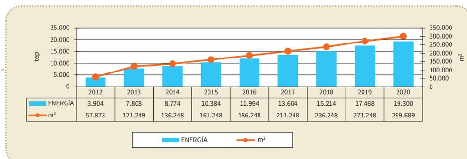
Para Aragón se ha supuesto un escenario para 2020 de 300.000 m<sup>2</sup> instalados, lo cual equivale a una producción de 20.000 teps, que aproximadamente equivale al 3% que prevé el Plan de Energías Renovables 2010 – 2020 para España. Todo esto implica un incremento de unos 243.000 m<sup>2</sup> a lo largo del periodo, con una producción térmica acumulada en el mismo de unos 104 kteps.
