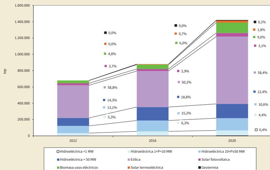
Como puede observarse en las gráficas, el incremento de potencia previsto para las tecnologías de usos eléctricos es de 3.845 MW (de 3.691,6 a 7.537 MW). El mayor incremento en términos absolutos, en potencia y en energía, se da en la eólica que en el caso de la potencia instalada pasa de los 1.873,07 MW actuales a los 4.000 MW previstos en 2020, lo cual supone un incremento de 2.127 MW, es decir aproximadamente un 55% del incremento total de 3.845 MW.
