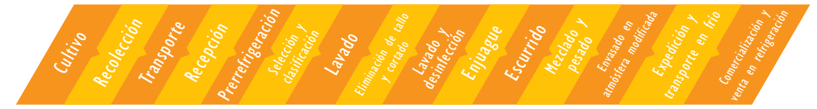
Figura 2 DIAGRAMA DE FLUJO DE PREPARACIÓN DE HORTALIZAS MÍNIMAMENTE PROCESADAS
