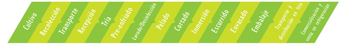
Figura 2 DIAGRAMA DE FLUJO DE PREPARACIÓN DE HORTALIZAS MÍNIMAMENTE PROCESADAS
