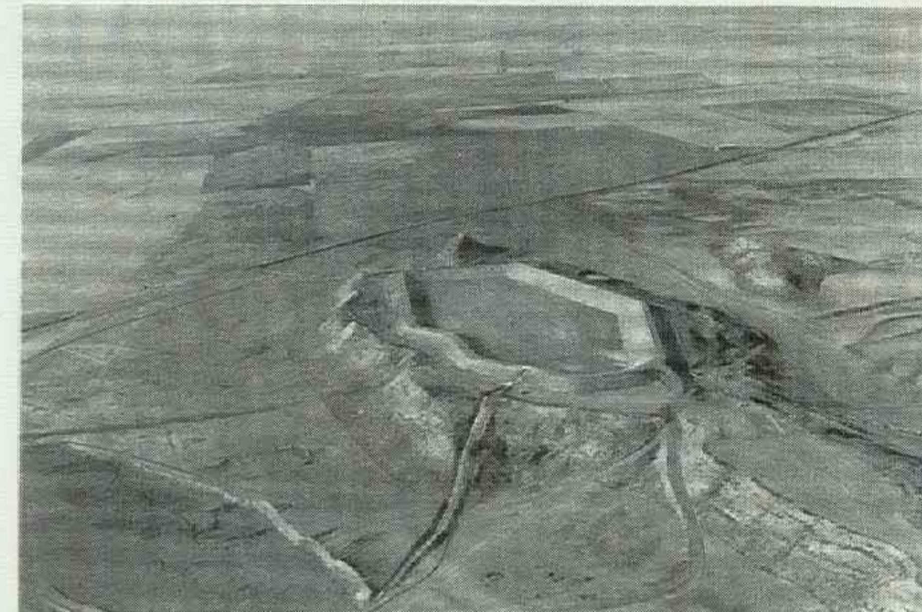
El embalse de 105.000 m 3 se llena durante las "horas valle", cuando el coste de la energía es menor.
