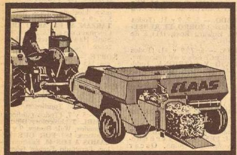
La empacadora CLAAS es una prensa recogedora-empacadora de alta presión. Trabajando según el sistema del pistón horizontal deslizante, consigue empacar toneladas de heno y paja en una hora.
