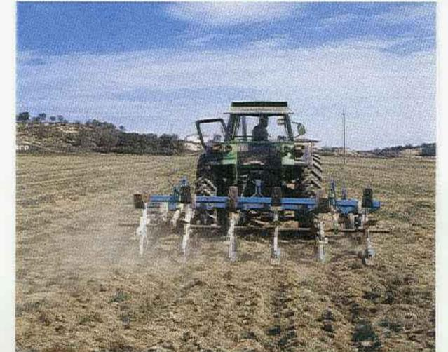
El empleo del «chisel», unido a bacheadores de paletas, reduce la erosión y mejora la capacidad de infiltración del suelo.
