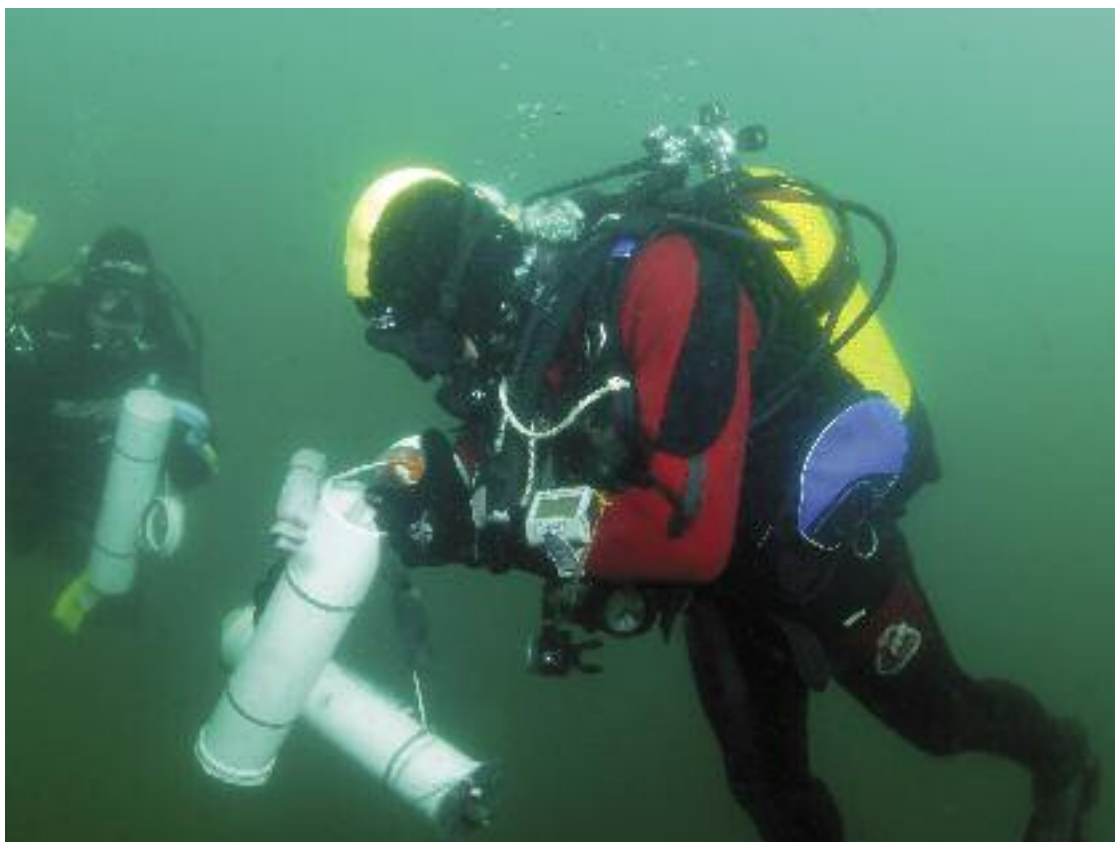
La toma de muestras de agua en inmersión requiere una técnica y material muy específicos. De hecho, los investigadores optaron por diseñar sus propias botellas de muestreo subacuático, empleadas con éxito en las diversas tomas de muestras. (José Manuel Cruz)
