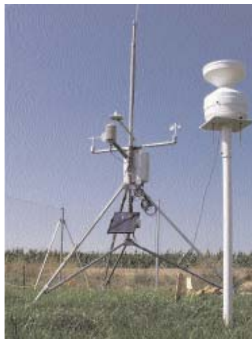
Estación agroclimática para medir la evapotranspiración de referencia.
