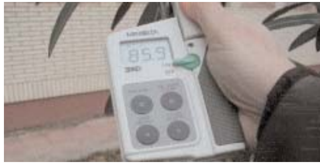
Control del nitrógeno en hoja mediante el índice SPAD
