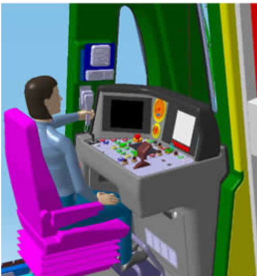
Alcances para el 5 percentil femenino en un puesto de conducción de Metro de Delhi.
