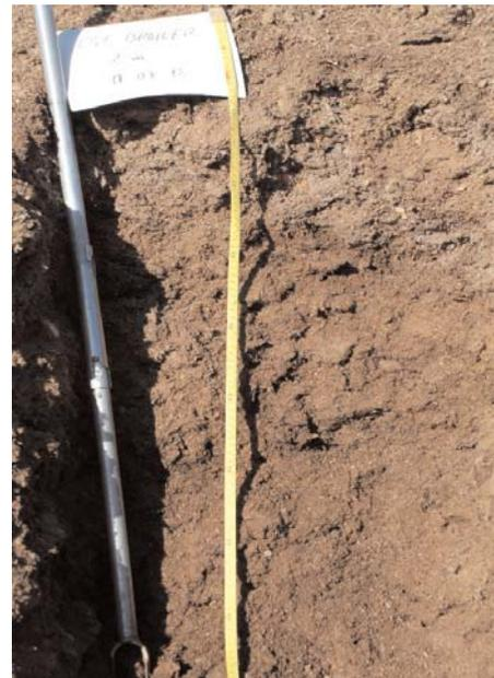
Fig. 5.1: Imagen de un corte vertical del acopio muestreado. Véase el aspecto claramente diferente de la capa superficial.
