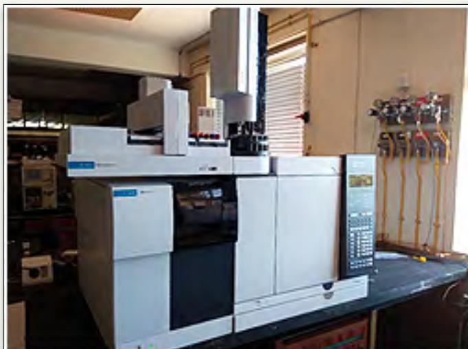
Se acaba de instalar en el Laboratorio Agroambiental un nuevo Cromatógrafo de Gases con detector de Espectrometría de Masas de Triple Cuadrupolo, que va a permitir realizar todo el Programa Coordinado de determinación de residuos de plaguicidas de la Unión Europea.
