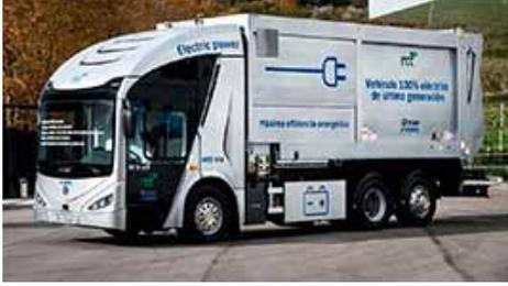
ie-Urban: Vehículo recolector-compactador eléctrico plug-in autocargable desarrollado con la plataforma FCC de e-movilidad.
