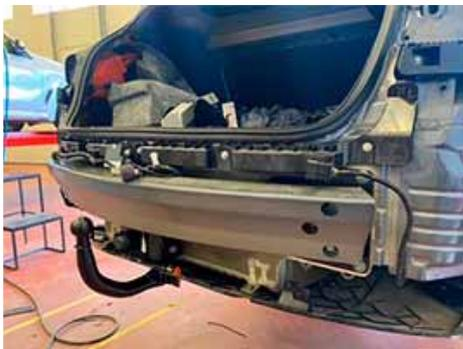
Montaje del dispositivo en el modelo Tesla.
