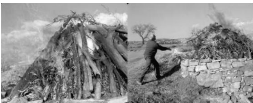
Fotos nº 28 y 29. Encendido y mantenimiento del horno.
