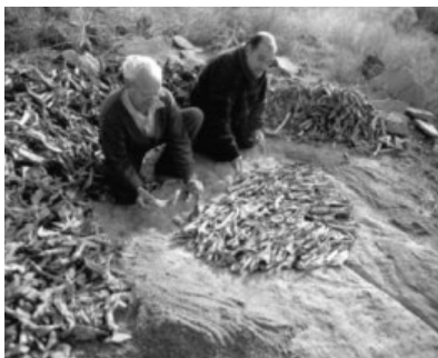
Foto nº 19. Primera capa de teas tapando los conductos o “riolas”.
