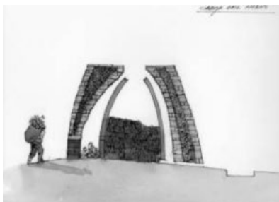
Foto nº 51. Dibujo de Manuel Macías en el que se muestra la carga del horno hasta superar la altura de la puerta de la olla.
