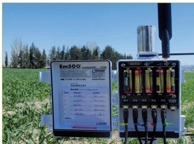
Fig. 2. Datalogger modelo Em50G. Sistema de almacenamiento de datos con conexión remota.
