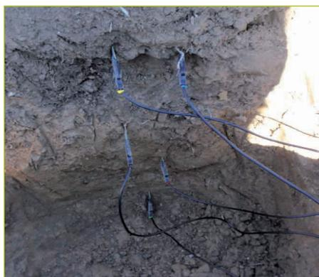
Fig.4. Cata realizada para la instalación de la estación que contiene las sondas modelo 5 TE instaladas a diferentes profundidades.
