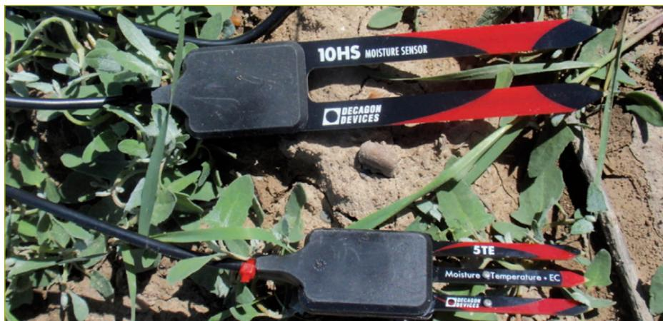
Fig. 3. Sonda de humedad modelo 10 HS (parte superior) y sonda modelo 5 TE para medir conductividad eléctrica y temperatura y humedad del suelo (parte inferior).
