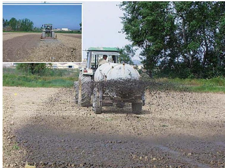
Figura 1. Aplicación convencional en abanico y enterrado posterior (detalle superior).
