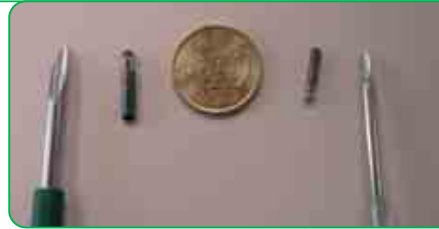
En la imagen se observan los microchips empleados para la identificación de caballos y perros. Su implantación es subcutánea.
