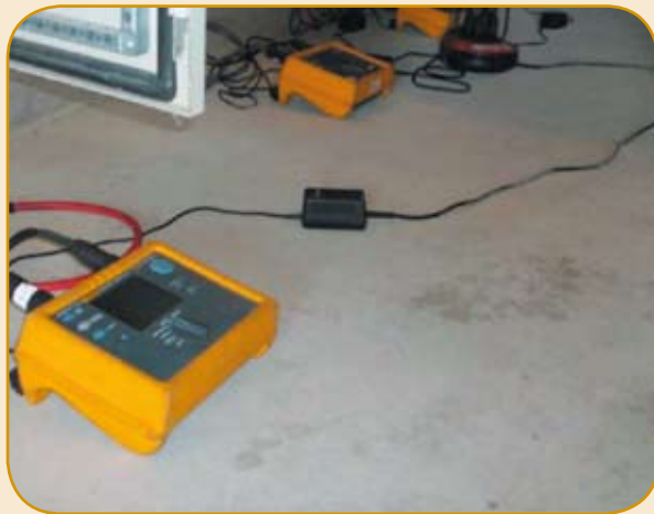
Los Analizadores de redes permiten obtener datos de consumo energético de las bombas de riego.
