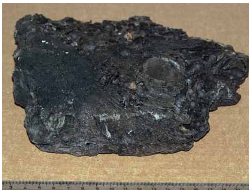
Muestra de madera (s. XVI) con perforaciones de teredo, consolidada con PEG 3000 y liofilizada
