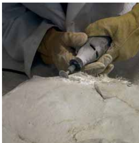
Repaso de bordes con pequeñas amoladoras
