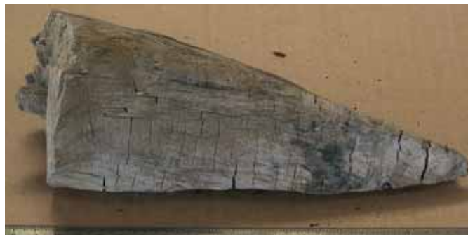
En la imagen izquierda, madera de conífera (s. I a. C.) tratada con PEG al 20% y liofilizada. Imagen derecha, idem , tras un proceso inadecuado de secado
