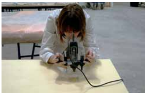
Realización del cajeadado para los anclajes en el poliestireno extruido
