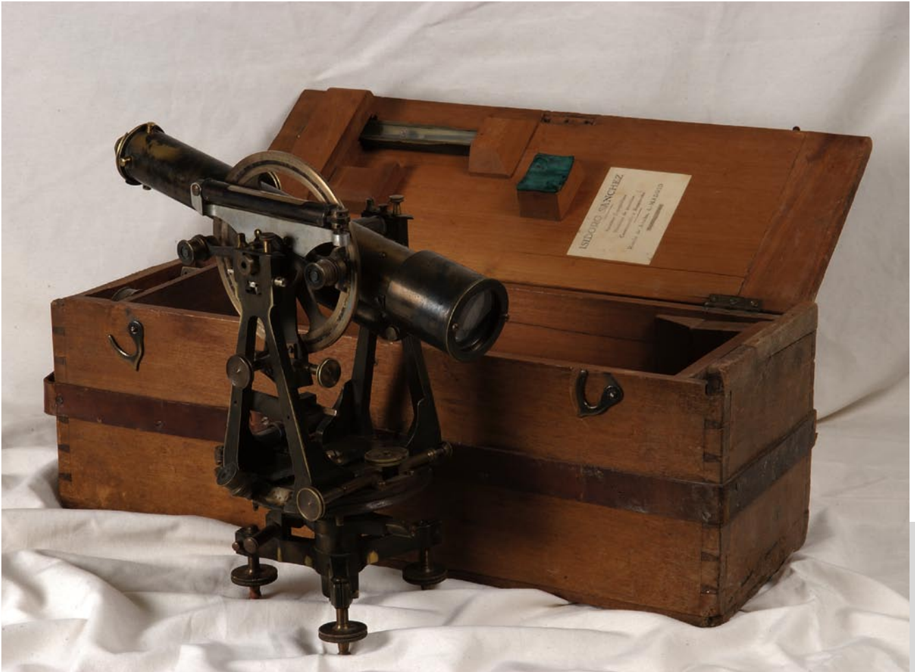
Teodolito utilizado por los técnicos de la Dirección General de Regiones Devastadas. Metal. Estuche de madera Servicio Provincial de Obras Públicas, Urbanismo y Transportes de Teruel
