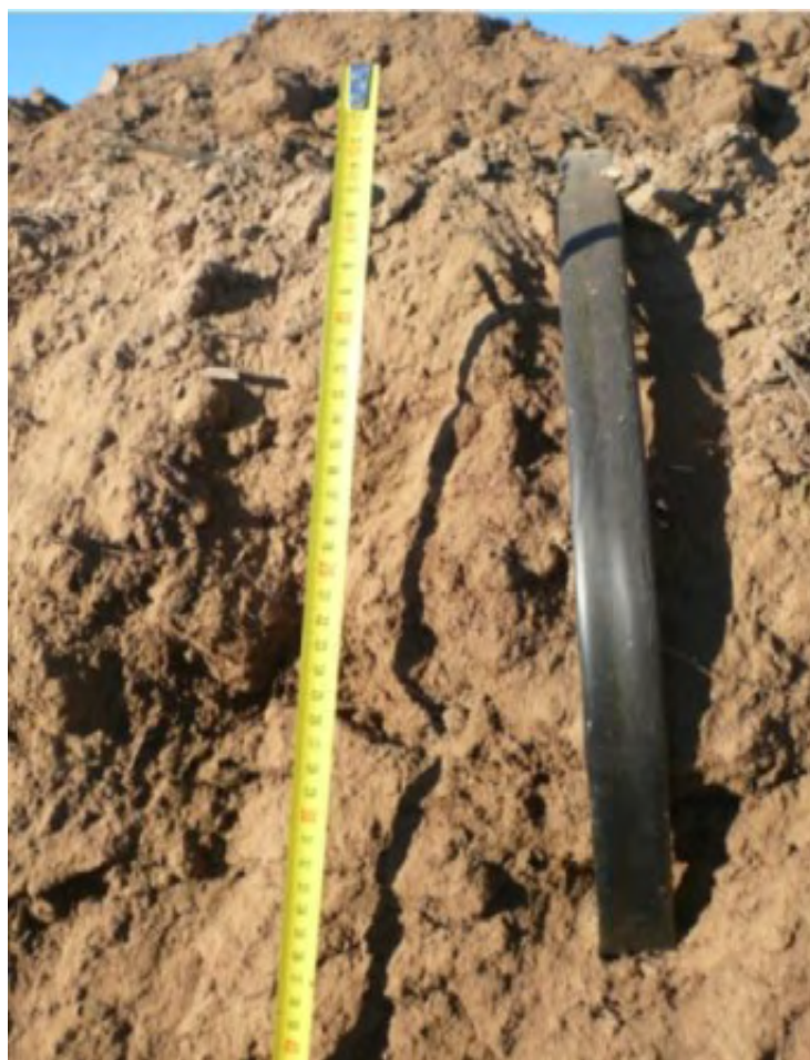
Figura 4. Profundidad de la tubería
