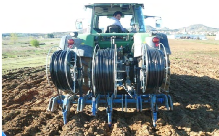
Figura 3. Aperi para instalación de tubería emisora
