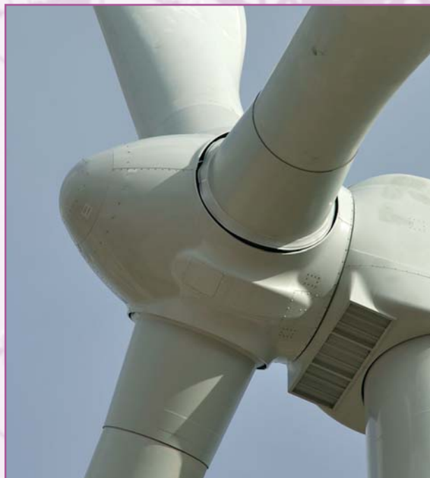
Buje del aerogenerador de 4.5 MW (Jaulín, Zaragoza)
