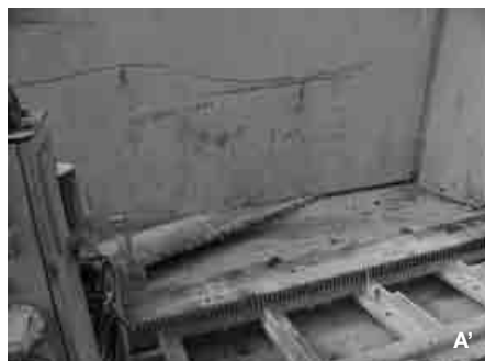
Figura A'. Sistema de corte mediante rozadora de brazo en la cantera "Leonardo"
