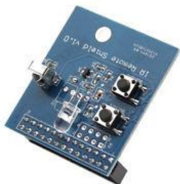
Figura 52. (A) Módulo IR instalado.
