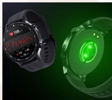
Imagen 6: Sensor óptico en un reloj inteligente
