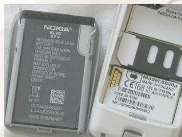
Imagen 7 Batería de teléfono móvil
