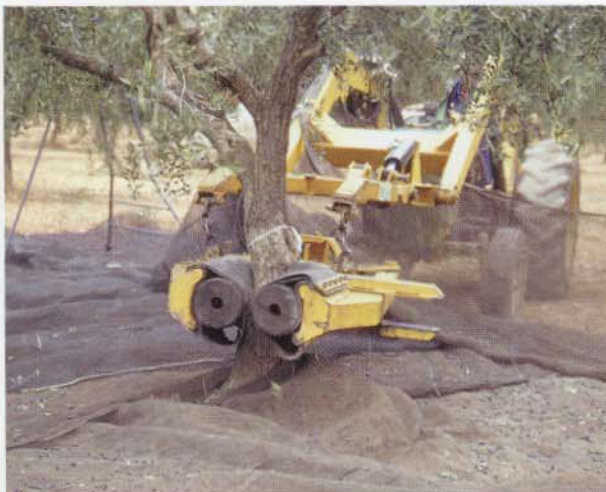
Foto 2. Detalle del vibrador multidireccional de troncos.
