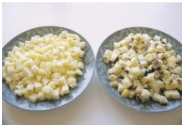
**Foto 6.** La separación y eliminación de los dados inservibles por su color oscuro se efectúa mecánicamente gracias a detectores colorimétricos.
