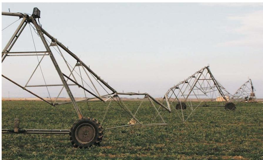
Si el hielo se acumula sobre un pivote, el peso puede deformar la estructura mientras la máquina sigue en funcionamiento.
