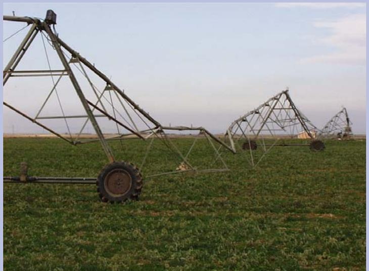
*Foto 2: Si el hielo se acumula sobre un pivot, el peso puede deformar la estructura mientras la máquina sigue en funcionamiento.*
