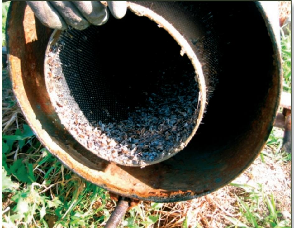
Foto 2: Restos de valvas de mejillón en filtro de hidrante.
