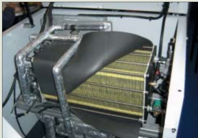
Pila de combustible para uso residencial de 5 Kw.
