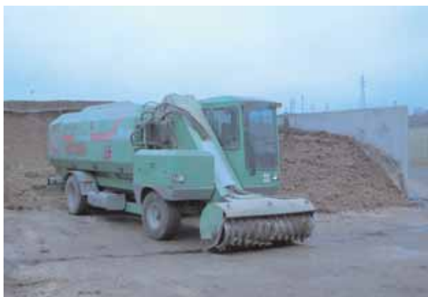
Carro mezclador autopropulsado, en un silo trinchera
