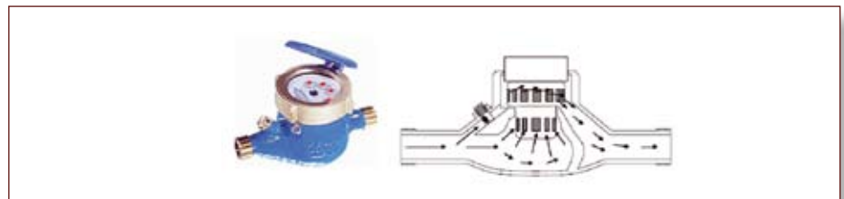
Fig. 1, 2. Caudalímetro de chorro múltiple. Esquema de funcionamiento.
