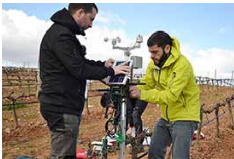
Técnicos de Libelium y remOT Technologies instalando los nodos Waspote Plug & Sense! Smart Agriculture.
