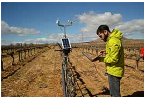
Configuración de Waspote Plug & Sense! Smart Agriculture.
