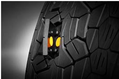
ContiSense, de Continental, con uno de sus sensores a la vista.
