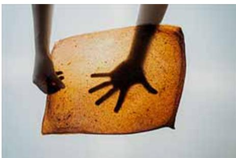
Cuando el agua se evapora, se genera una suerte de cuero semirígido muy resistente a la tracción.
