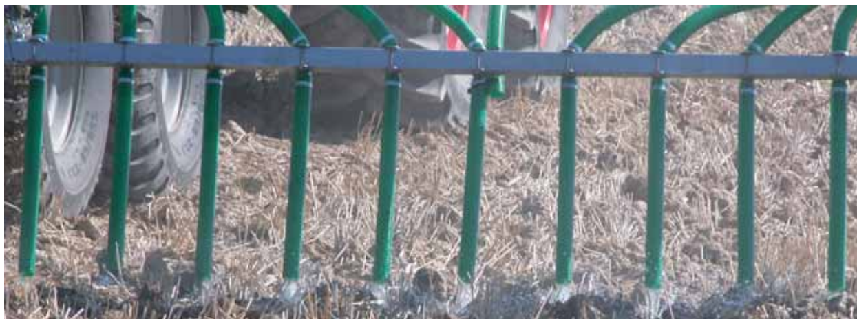
Equipo de "tubos colgantes", detalle.
