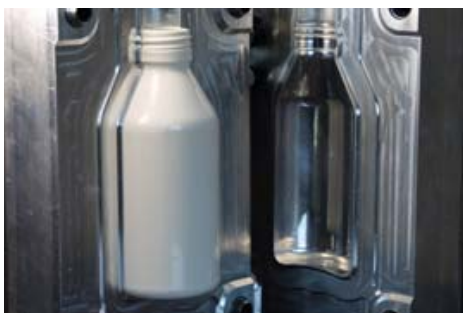
Botella para la industria farmacéutica y su molde. Material inyectado: PLA. Proyecto Dibbiopack. Fuente: Aitiip.
