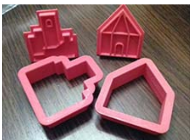
Moldes impresos en 3D con tecnología FDM.
