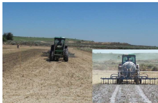
Foto 3. Aplicación del purín en la parcela y detalle de la maquinaria utilizada. Autora: Beatriz Moreno.
