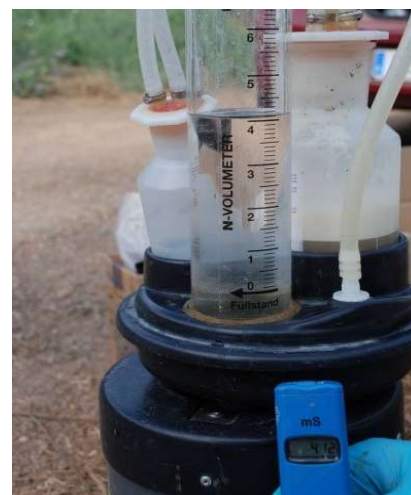
Análisis de la concentración de N amoniacal del purín mediante Quantofix y conductimetría. Autor: Francisco Iguácel.
