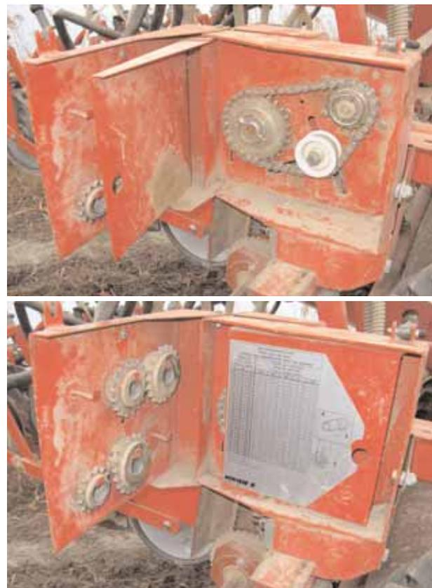
Fig. 3. Engranajes para regular la densidad de siembra
