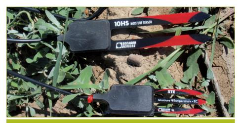
Fig. 3. Sonda de humedad modelo 10 HS (parte superior) y sonda modelo 5 TE para medir conductividad eléctrica y temperatura y humedad del suelo (parte inferior).
