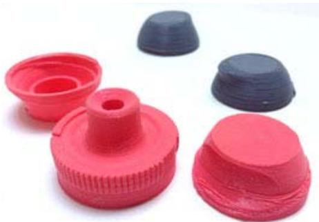
Proceso de prototipado por impresión 3D FDM.
