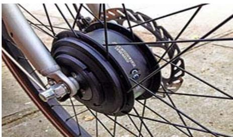
Vista en detalle del motor de eje en la rueda delantera.
