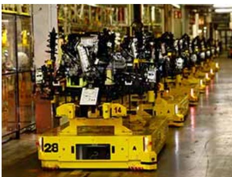
AGVs con elementos mecánicos, entre ellos baterías que se desplazan hacia el casamiento del motor.
